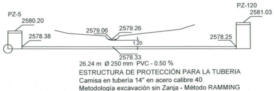
**Figura 11.** Perfil del detalle de la instalación de la red 250mm PVC.
